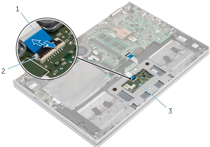
1 Kabel sledilne ploščice
