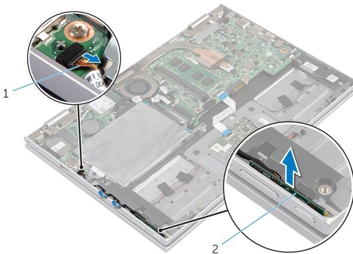
1 Kabel plošče z gumbi za napajanje in nastavitev glasnosti
